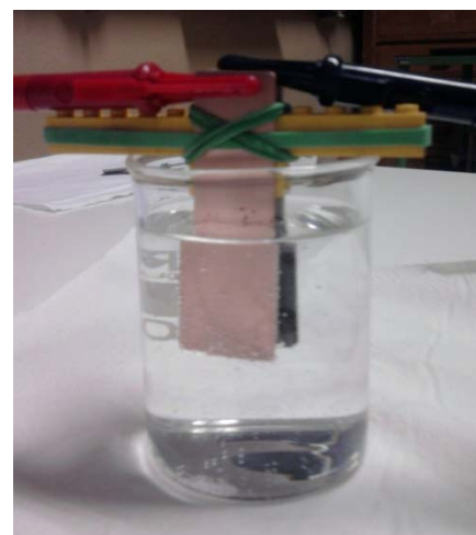
Fig 2.1: cella galvanica in funzione
